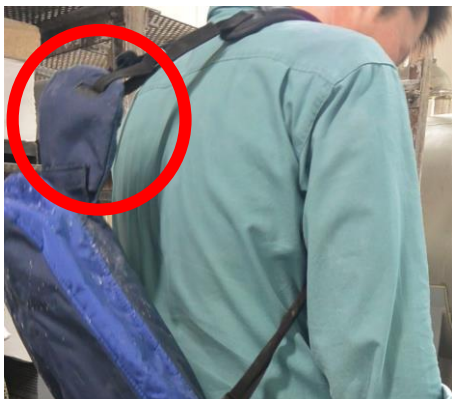
低い位置での作業では「○」の位置のように、背中と本体の間を更に広く開けることで、しゃがみ込む姿勢が取りやすくなる。
