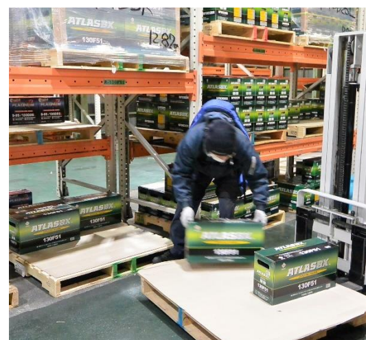
手順②：バッテリーをパレットに積み替えていく。一番下のバッテリーを持ち上げる際、作業負荷が特に高い。
