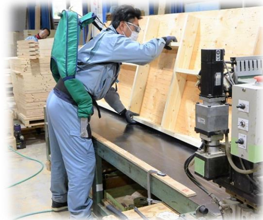
重さ約20kgにもなるパネルをき打ちを行い別の棚に移し替えていく。この作業は従業員1名で行うため、疲れが出て作業効率下がってしまうことがあった。マッスルスーツ®でその負担を軽減し、身体を守りながら安心して作業に集中することができる。
