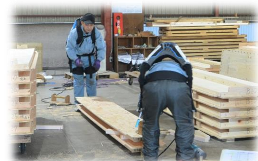
膝の高さにあるパネルをベアで持ち上げ運ぶ作業。持ち上げる際には中腰ひざぎざるを得ないため、腰痛の原因になっていた。ここで使用されているマッスルスーツ® スタンドアロンモデルのソフトフィットは、腿/バッドと腿の間で少し空間ができるよう設計されているため、容易に歩くことができる。
